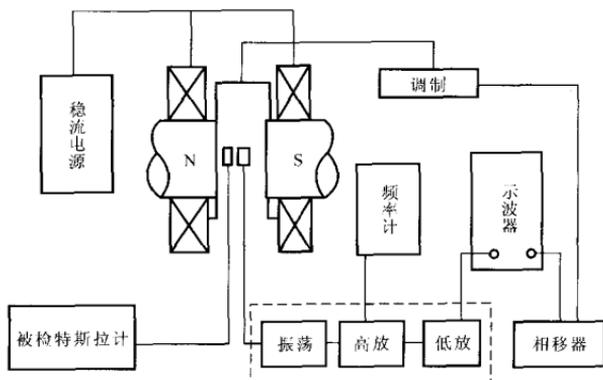
图 1 核磁共振检定装置原理图
