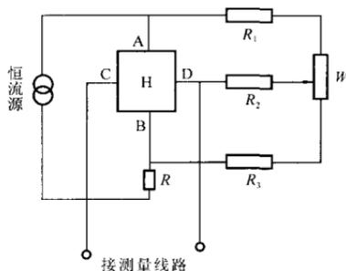
图3 霍尔特斯拉计的原理电路
